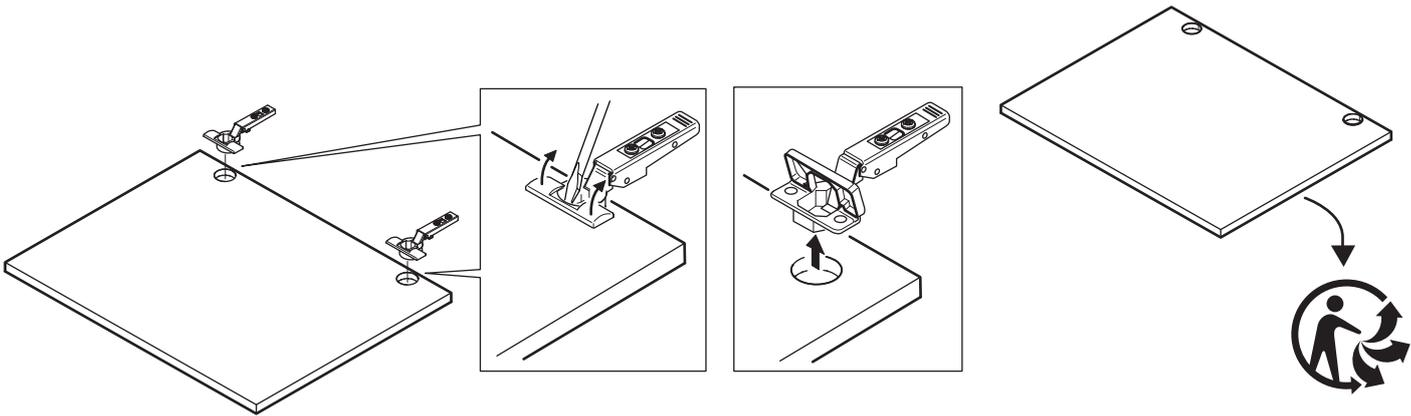
**i** Pour retirer les charnières, ouvrir le capot du boîtier à l'aide d'un tournevis plat.
