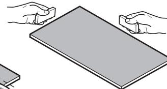
**i** Pour éviter les éclats, faire la coupe en positionnant le côté visible du panneau en dessous. Les côtés découpés ne doivent pas être visibles une fois le panneau monté sur le meuble.
